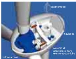
Un campo eolico è un insieme di più aerogeneratori che trasformano l'energia cinetica del vento in energia elettrica. Un sistema di pale accoppiato a un generatore-trasformatore consente di produrre l'energia elettrica. La tecnologia impiegata nei campi eolici di Edison si basa sugli aerogeneratori "tripala" di nuova concezione della potenza di circa 0,6 MW per macchina.
