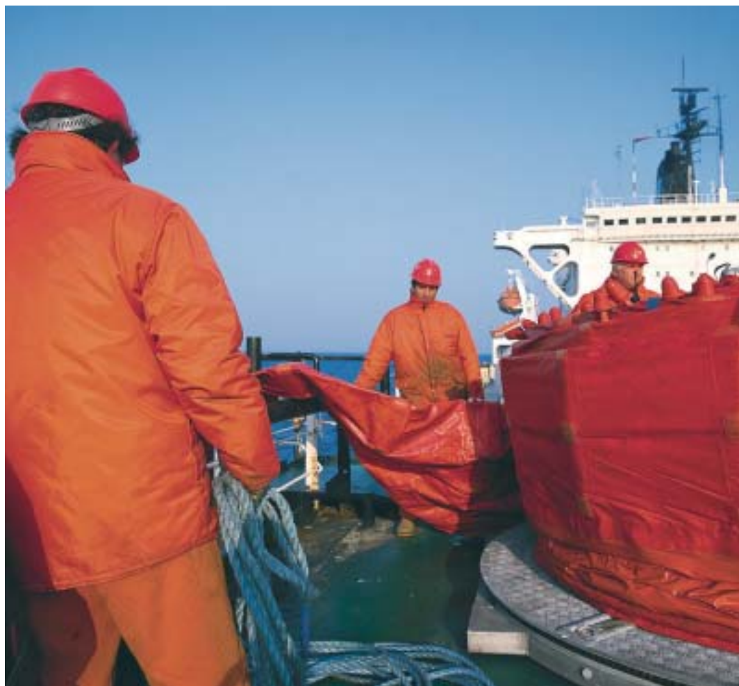
Nave Alba marina. Barriere galleggianti contro la dispersione in mare dell'olio durante le operazioni di carico e scarico.
